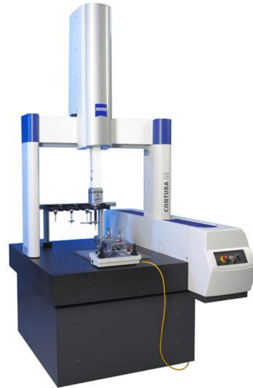
Portalna noseća struktura sa pokretnim portalom
